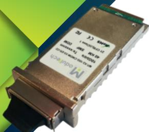
**Трансиверы X2** — съемные оптические трансиверы соответствующие промышленному стандарту 10GBASE-X2, используются для организации двунаправленного канала передачи данных до 10Гбит/с по двум одномодовым волокнам или многомодовым волокнам, а так же могут быть задействованы в рамках CWDM или DWDM системы спектрального уплотнения. Оптические трансиверы X2 позволяют передавать данные по протоколу Ethernet.
