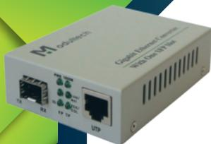
**Медиаконвертеры с SFP портом** — конвертер среды передачи данных, используются для преобразования среды распространения сигнала из оптической в электрическую. Средой распространения сигнала являются медные провода и оптические кабели.
