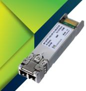
Двухволоконные SFP plus трансиверы — съемные оптические модули соответствующие промышленному стандарту Enhanced Small Form-factor Pluggable, используются для организации двунаправленного канала передачи данных до 14,02 Гбит/с по двум одномодовым волокнам или по двум многомодовым волокнам. Оптические трансиверы SFP+ позволяют передавать данные по протоколам Ethernet, SDH/SONET, FiberChannel, OTN.
